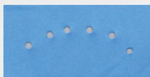
PAC-DAMテンプレート使用後の穿孔
