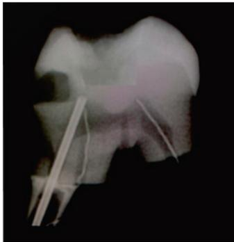
図2. X線画像から熱電対の位置および残存象牙質厚径の確認
