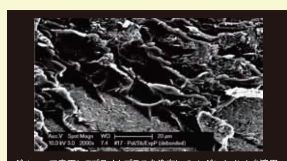
ジルコニア表面にZプライムプラスを塗布して、レジンセメントを適用した後に、引張せん断強さ試験を行った凝集破壊像。ジルコニアとZプライムプラスの接着界面は破壊せず、セメント層内で破壊していることがわかる。
