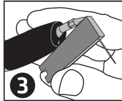
③レンチを最後までスライドさせた状態で、チップの根元の部分を推奨した角度(70° ~ 90°)に曲げます。
