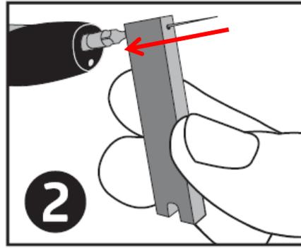
②アクチベーターチップを付属のレンチのホールに挿入し、最後までスライドさせます。
