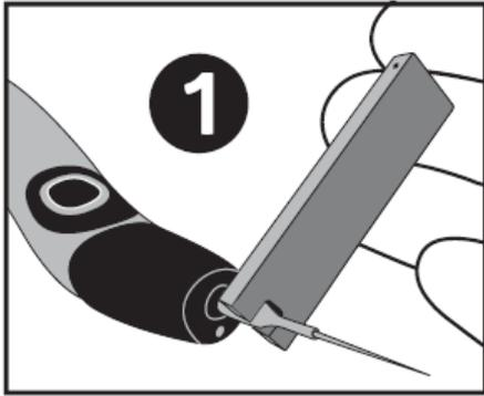
①手でアクチベーターチップをハンドピースにねじ込み、付属のレンチでアクチベーターチップが回らなくなるまで締めます。
