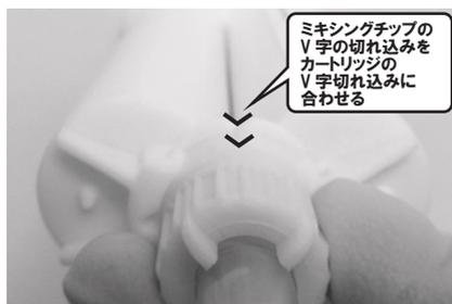
ミキシングチップのカートリッジ取付部辺縁周囲にあるV字の切れ込みを、カートリッジのV字切れ込みに合わせ、無理のない様な力で挿入し、時計方向に90度回転させ、装着固定します。抜けないことを確認します。
