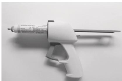
カートリッジをカートリッジディスペンサー（カートリッジガン）に、カートリッジディスペンサー製造者の指示に従い、装着します。
