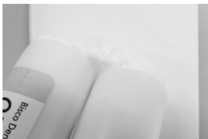
約6~7mmの長さでミキシングパッド等に押し出し、一様に押し出されることを確認します。
