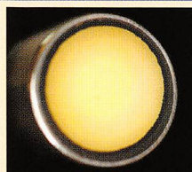
図5 適正な光強度、照射プローブの先端はクリーンで破損が無いこと
