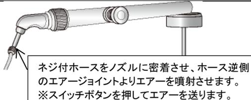
※ノズルの詰まりの除去後、マイクロエッチャーを組み立てて、パウダーが噴出されるかを確認してください。
