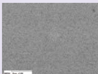
図2 CAD/CAMレジンブロックの研磨面性状を示す。実験のベースラインとなる面である。
