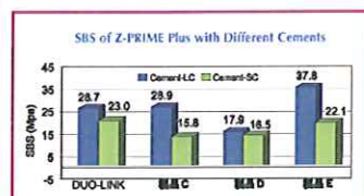
図6. Zプライムプラスと他社セメントを併用した際の引張り剪断接着強度。Zプライムプラスは他社レジンセメントの接着強度も著しく高める。
