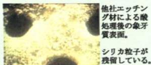
他社エッチング材による酸処理後の象牙質表面。シリカ粒子が残留している。
