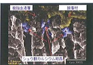
写真はスーパーシール塗布後に接着材を塗布した象牙質SEM像です。スーパーシールは樹脂含浸層の形成を阻害していないことがわかります。
