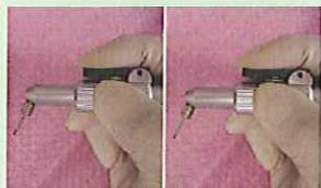
図5 噴射ボタンでエアー量が調節できる
